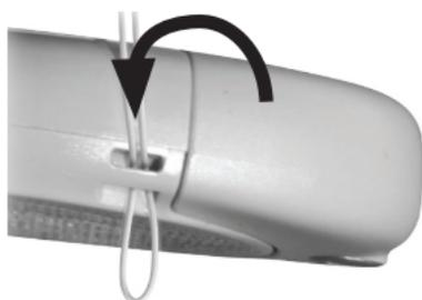
2. Проденьте петлю сквозь крепежное отверстие в звуковом процессоре в направлении **спереди назад**.
