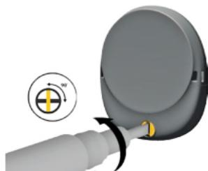
1. Если крышка батарейного отсека заблокирована, разблокируйте ее, повернув фиксирующий винт против часовой стрелки.
