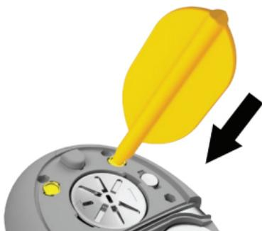
4. **Плотно прижмите** кончик инструмента для извлечения к средней части колпачка микрофона.
