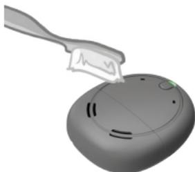
Если песок или грязь все же попали в процессор, аккуратно удалите их щеточкой из всех выемок и отверстий в корпусе процессора.
