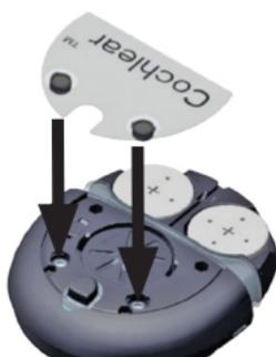
2. Поверните аппликатор колпачками микрофонов вниз и наложите его на процессор так, чтобы колпачки микрофонов находились на микрофонах.
