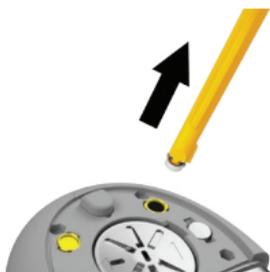
6. Приподнимите и извлеките использованный колпачок микрофона.
