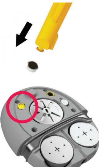
7. Снимите использованный колпачок микрофона с инструмента и утилизируйте его.
