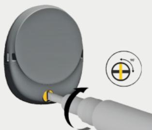
1. Чтобы заблокировать крышку, с помощью инструмента для блокировки крышки батарейного отсека поворачивайте фиксирующий винт по часовой стрелке до тех пор, пока его шлиц не окажется в горизонтальном положении.
